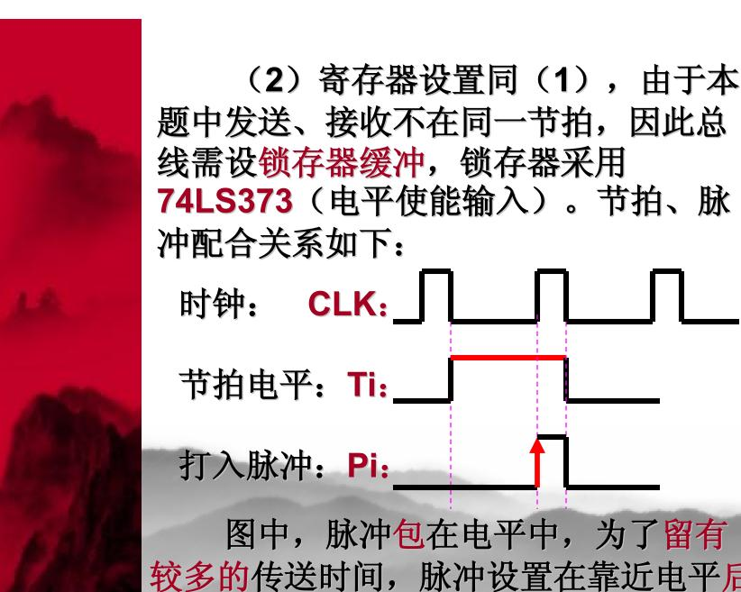
图中,脉冲包在电平中,为了留有 较多的传送时间,脉冲设置在靠近电平后 沿处。
